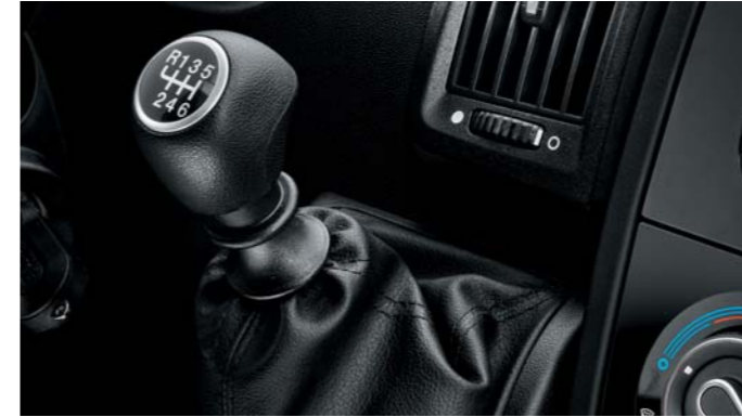
6-sebességes manuális sebességváltó kar.
