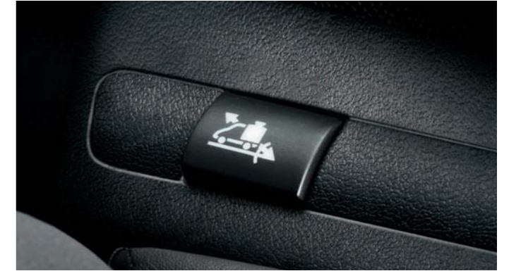
Up funkció gomb a műszerfalon a teli rakománnyal való közlekedés megkönnyítésére.
