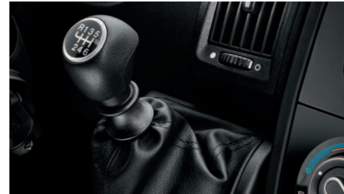
6-sebességes manuális sebességváltó kar.
